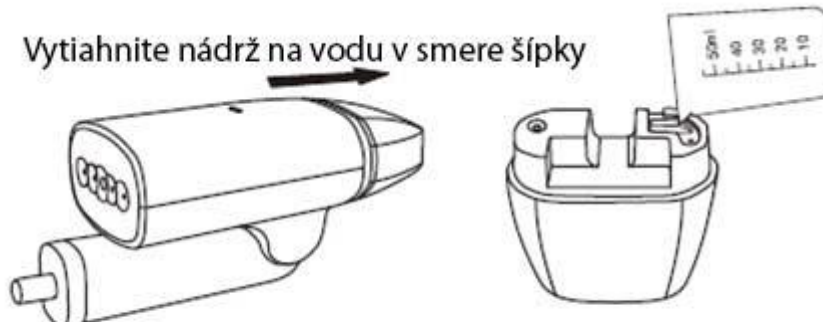
Demontáž nádrže na vodu
